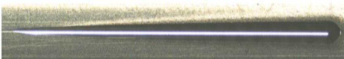
Рис. 2. Пример изображения царапины при некорректном определении верхней точки окружности цилиндрического образца
